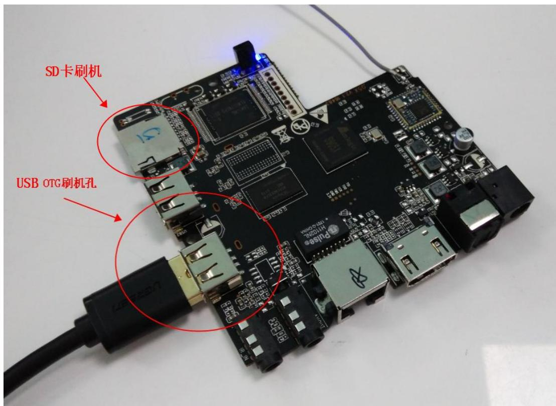
3、如图，按住 AV 孔的复位键后，插上电源
