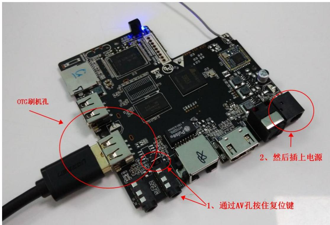
4、接着显示屏会开机后显示安卓 LOGO（此时刷机中，不可断电或插拔电源！），可不必再按住 AV 孔复位键
