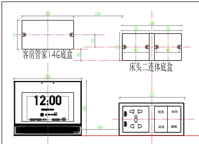
注：客房管家左右放，建议产品底部为同一水平线。产品安装完成间距80-100mm。底盒左右间距130mm，底盒底部间距30mm。
