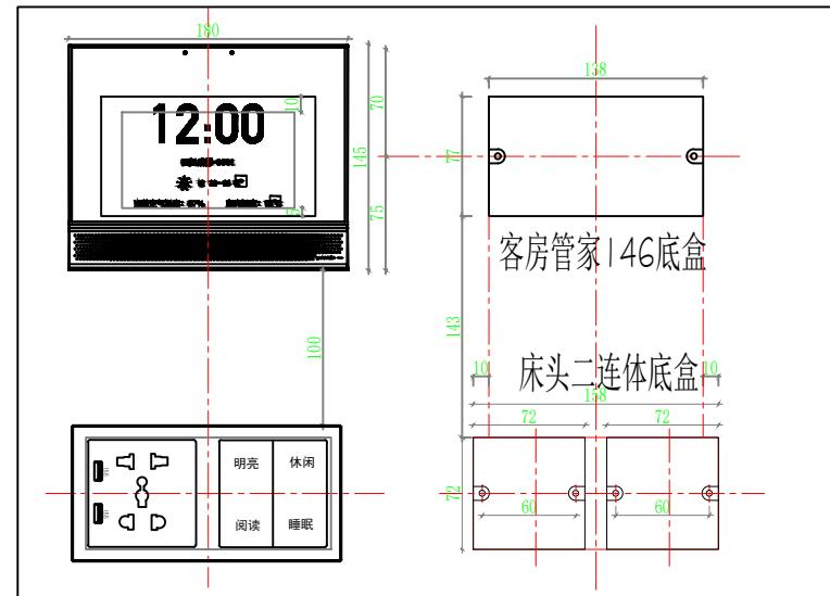
注：客房管家上下放，建议产品为同一中轴线。产品间安装完成间距80-100mm。底盒上下间距143mm。
